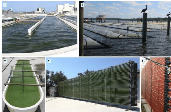
شکل ۲- (۱ حوضچه باز ۲) های PBR (Photo bio reactor) بسته دریایی شناور با ظرفیت هر کدام ۸۰۰۰ لیتر (۳ حوضچه ای ۱۰۰۰ لیتری و ۴ و ۵) PBR های لوله ای ۴۰۰۰۰ لیتری در مقیاس بزرگ
